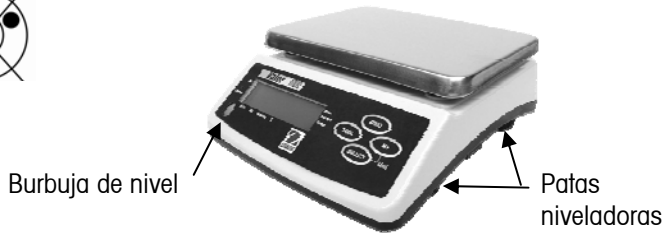
Figura 2-1. Nivelación de la báscula.
